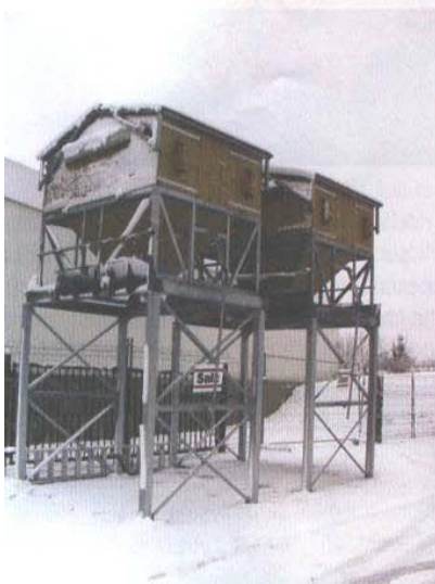
temps de chargement est réduit dans le cas de stockage vertical en silos : en 2 minutes, l'opérateur peut charger tout seul son camion.
