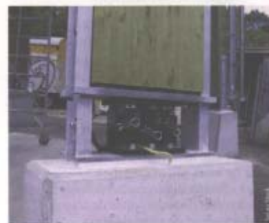
Dispositif de pesage du poids total restant
